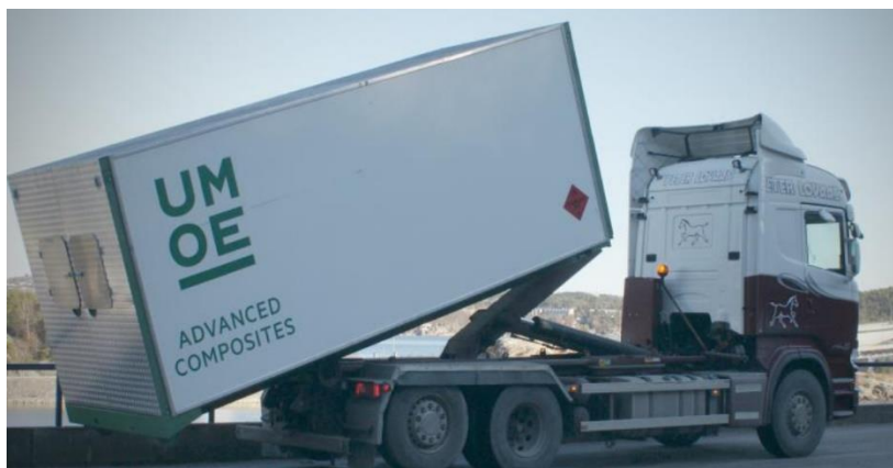
Figura 56: Modelo de almacenamiento de hidrógeno en container de 450 bar.
